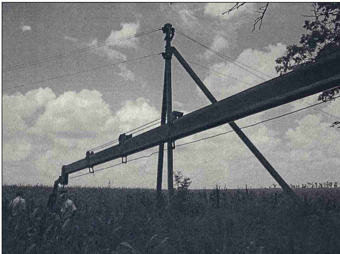
Стрела автовышки грузового автомобиля, подведённая к ЛЭП
